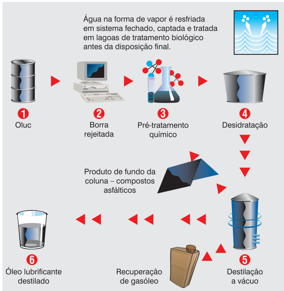
Figura 2 – Primeira etapa de destilação a vácuo.
