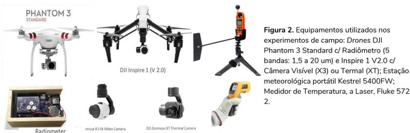
**Figura 2.** Equipamentos utilizados nos experimentos de campo: Drones DJI Phantom 3 Standard e/ Radiômetro (5 bandas: 1,5 a 20 um) e Inspire 1 V2.0 e/ Câmera Visível (X3) ou Termal (XT); Estação meteorológica portátil Kestrel 5400FW; Medidor de Temperatura, a Laser, Fluke 572-2.
