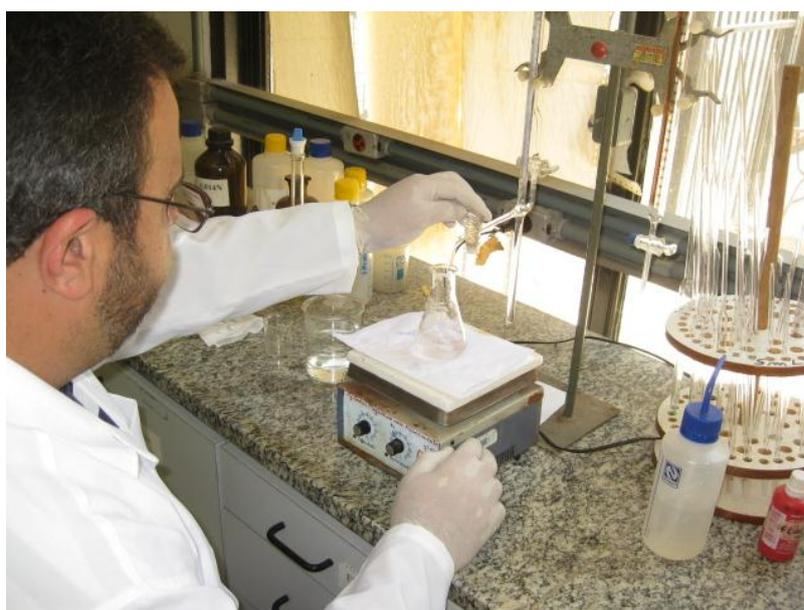
**Figura 2.15** - Determinação de  $\text{CO}_2$  livre por meio de titulação.
