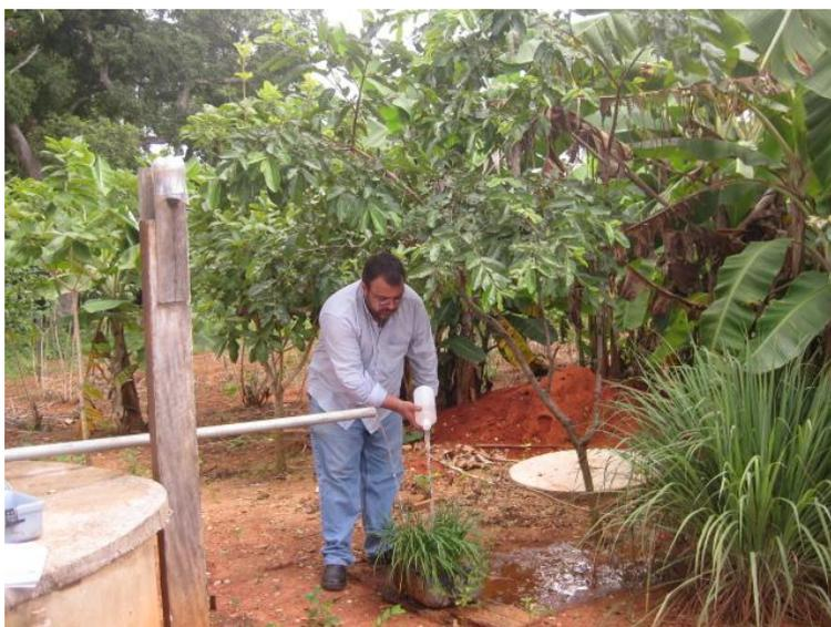
**Figura 2.7** - Procedimento de ambientação de frasco para coleta de amostra.
