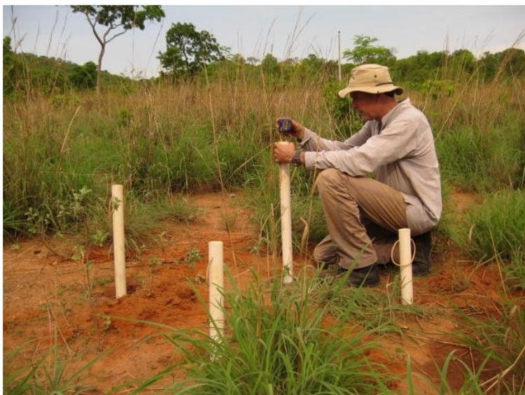
**Figura 2.11** - Ilustração da execução do ensaio de infiltração *in situ* pelo método *open end hole*.
