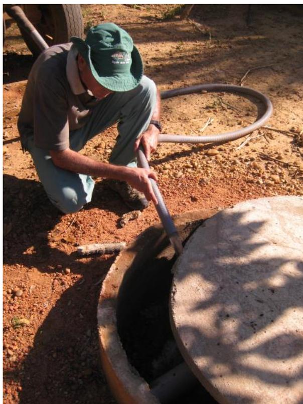
**Figura 2.10** - Detalhe da injeção de solução salina na caixa de recarga.
