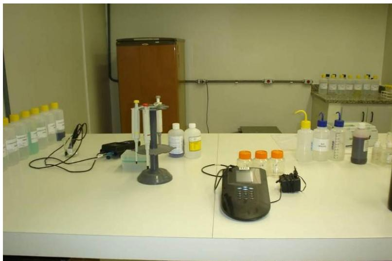
**Figura 2.16** - Multiparâmetro portátil da Hach, série Sension.
