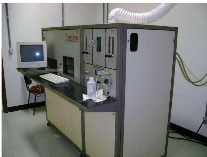
**Figura 2.13** - Espectrômetro de Emissão Atômica ICP/AES do LAGEq IG-UnB.
