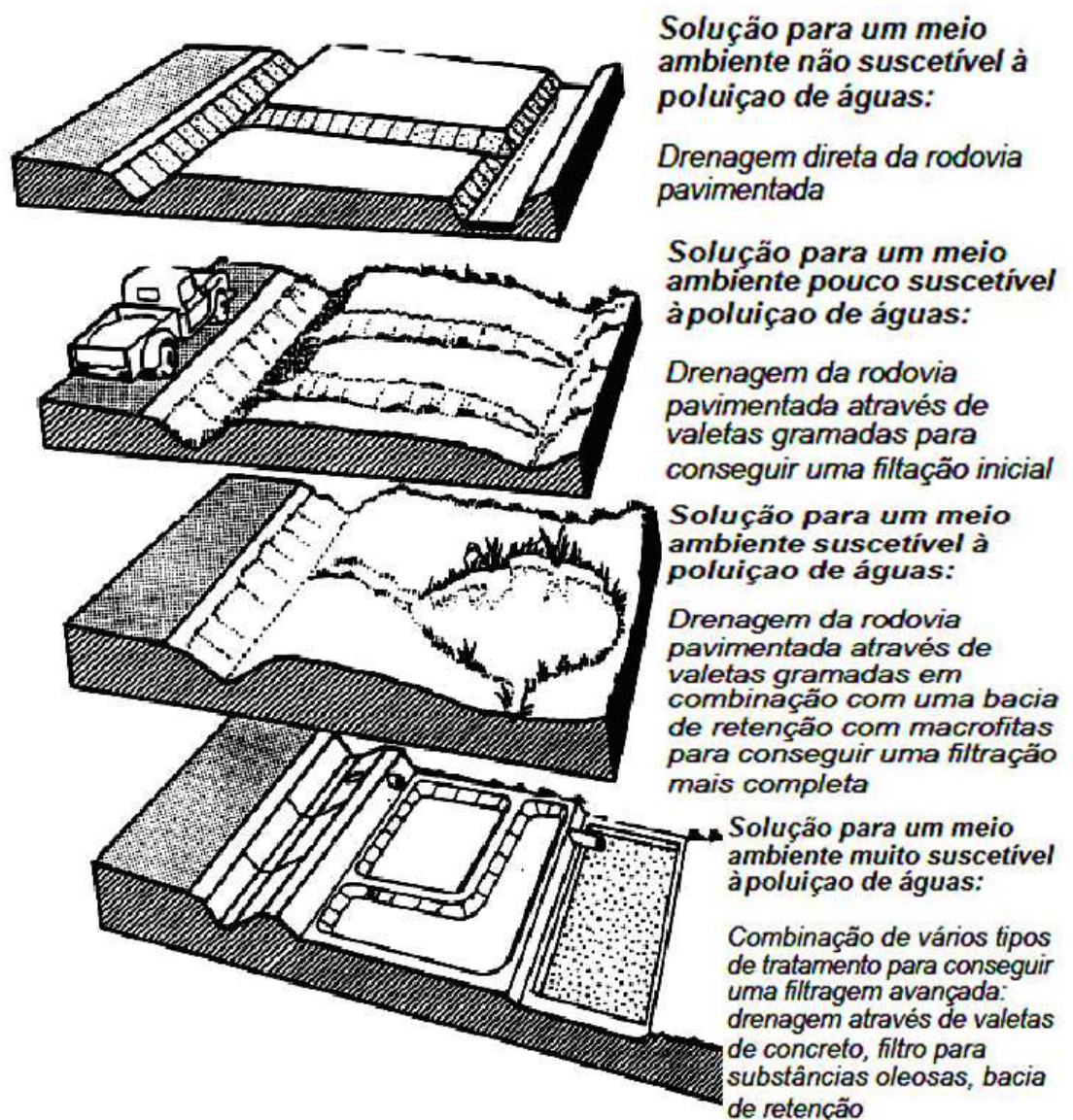
Figura 31 – Princípio de Drenagem para áreas com diferentes tipos de suscetibilidade ambiental.
