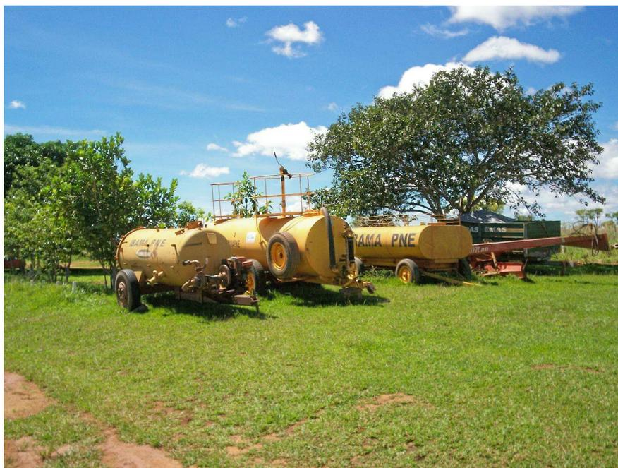
**Foto 4 – Tanques móveis – Implementos para Trator**
