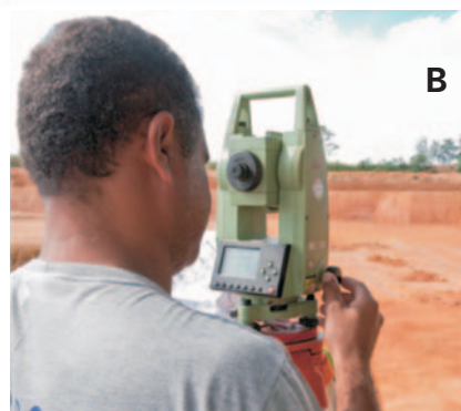
Figuras 6a e b – Altura do ninho em relação à lâmina d'água, feita por mangueira e régua topográfica (a) e teodolito (b).
