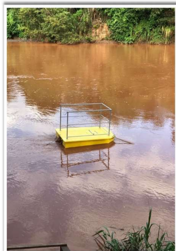
SONDA INSTALADA RDO03 EM CATAMARÃ
