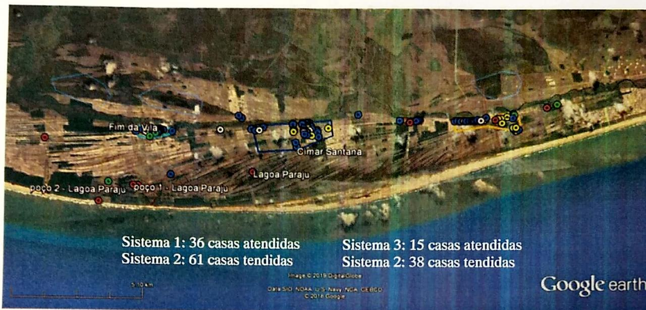
Figura 01: Proposta de implantação de quatro mini sistemas de abastecimento de água, em Degredo.
