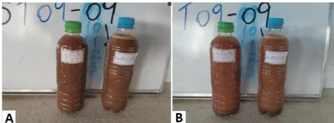
Figura 7: Foto A - Comparação entre o teste de mistura 100% (a esquerda) com o material coletado no ponto 9, transecto 9 após a agitação (a direita); Foto B - Comparação entre o teste de mistura 100% (a esquerda) com o material coletado no ponto 9, transecto 9 após decantação (a direita). Fonte: Volume 11 - Plano de manejo de resíduos do Trecho 15, Golder Associates (2020)
