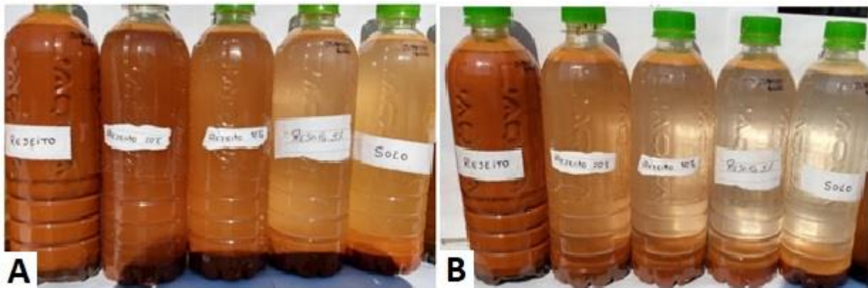
Figura 4: Técnica não visual realizada pela equipe de campo. Foto A: “teste de mistura” após agitação. Foto B: “teste de mistura” após decantação. Fonte: Volume 11 - Plano de manejo de rejeitos do Trecho 15, Golder Associates (2020)
