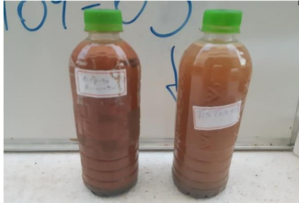
Figura 6: Comparação entre o teste de mistura 100% (a esquerda) com o material coletado no ponto 5 do transecto 9, no rio Doce (à direita). Fonte: Volume 11 - Plano de manejo de resíduos do Trecho 15, Golder Associates (2020)
