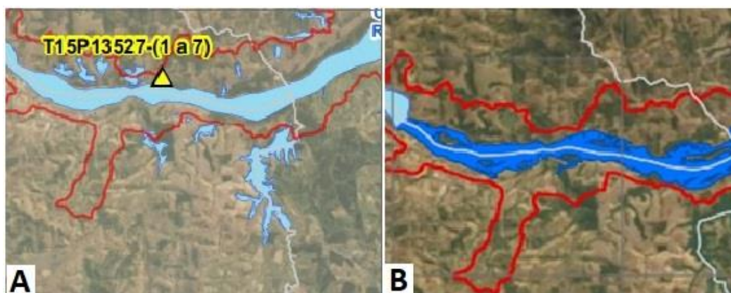
Figura 9: A) Recorte com a localização do ponto T15P13527; B) Recorte da mancha de inundação com o TR de 2 anos. Fonte: Volume 11 - Plano de manejo de rejeitos do Trecho 15, Golder Associates (2020)
