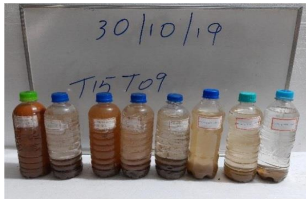
Figura 5: Comparação entre o “teste de mistura” com diversos teores de rejeito (à esquerda) e os sedimentos intracalha do transecto 9 (à direita). Fonte: Volume 11 - Plano de manejo de rejeitos do Trecho 15, Golder Associates (2020)
