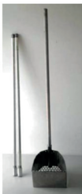
Figura 23. Concha raspadora para coleta de incrustações do mexilhão-dourado. Fonte: Pereira et al., 2012b.
