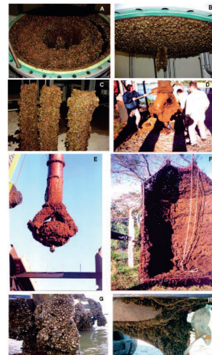
Figura 5. Substratos artificiais utilizados por Limnoperna fortunei : 3A, filtro autolimpante obstruído; 3B, detalhe da tampa; 3C, cilindros do interior do mesmo filtro; 3D, início do processo de limpeza de uma bomba captadora de água incrustada; 3E, bomba içada com guindaste pelo teto; 3F, grade protetora da bomba; 3G, trapiço de marinha; 3H, casco de embarcação utilizada para pesca no Lago Guaíba e Lagoa dos Patos, sendo transportada por rodovia para outro manancial, oferecendo risco de contaminação. Fotos: A, B, C Gustavo Darrigran, www.malacologia.com.ar ; D, E, F José Imada, CORSAN; G, Augusto Chagas: Biociências, 2004, 13(1); H, M.C.D. Mansur: Revista Brasileira de Zoologia 2003, 20(1). Fonte: Santos et al. (2012a), com permissão dos autores e editores.
