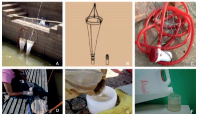
Figura 20. Coleta de amostras de plâncton para quantificação de larvas de L. fortunei . A) filtração em rede de plâncton, B) rede de plâncton, C) bomba de sucção, D e E) remoção da amostra da rede e F) fixação da amostra em álcool 80%. Fonte: Santos et al. (2012b), com autorização dos autores e editores.
