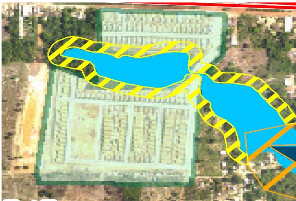
Figura 01: Projeção de APP 30 metros na área do reservatório próxima ao Reassentamento Parque dos Buritis
