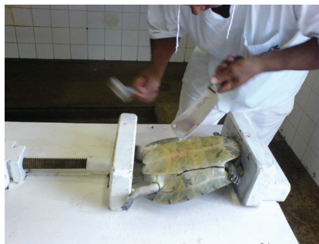
Figura 12 – Mesa-prensa experimental para o corte das pontes e descolamento do plastrão da tartaruga-da-amazônia.
